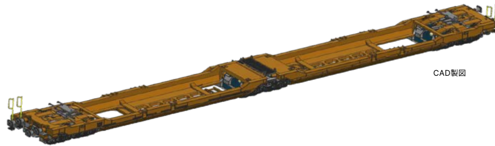
■ セミトレーラー積載時は高い位置に（上）、コンテナ積載時は低い位置（下）にある受け具
